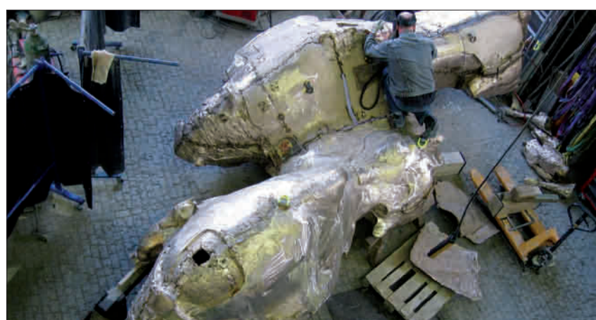
Für die Zentrale von Red Bull schuf der Osttiroler Künstler Jos Pirkner eine Plastik, die 12 lebensgroße Bullen darstellt. Gegossen wird diese von der Bildgießerei Noack in Berlin. Die 18 t schwere Skulptur muss aufwändig gepulvt, ziseliert und patiniert werden.
